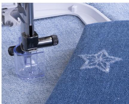
Con il Kit Ricamo feltratura PFAFF® creative™, è possibile creare i più stupefacenti ricami in feltro. L'effetto viene creato ricamando senza fili ma utilizzando un ago speciale che feltra insieme le fibre. L'effetto di abbellimento può essere modificato in maniera rilevante utilizzando diversi tipi di tessuto/lana.
