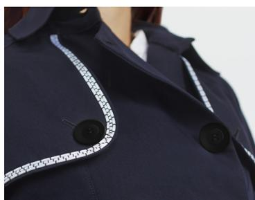
Impreziosisci la tua creazione con cordoncini o filati grossi di vario tipo usando gli splendidi punti da 9 mm PFAFF® e il piedino a tre fori per filati grossi. Il piedino guida facilmente i cordoncini attraverso le aperture anteriori della parte posteriore del piedino e poi lungo la scanalatura sotto la base. I cordoncini decorativi o i filati grossi verranno cuciti creando un bellissimo ricamo a treccia.
