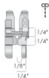
Il piedino per quilt 6 mm con guida a destra con IDT™ è stato progettato per farti ottenere delle cuciture con margine perfetto di 6 mm. Basta guidare il bordo del tessuto accanto alla guida. La distanza tra l'ago e la guida è di 6 mm. Il piedino per quilt 6 mm con guida a destra ti permette anche di cucire con un margine di 6 mm dal bordo di un blocco durante la trapuntatura del quilt.
